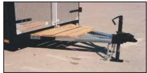
Top Wrapped A-Frame
